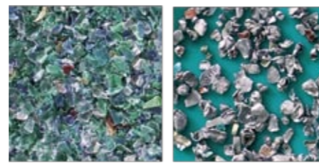
Small aluminium particles separated from grinded PET bottles. Piccoli residui di alluminio estratti da bottiglie di PET triturate.
